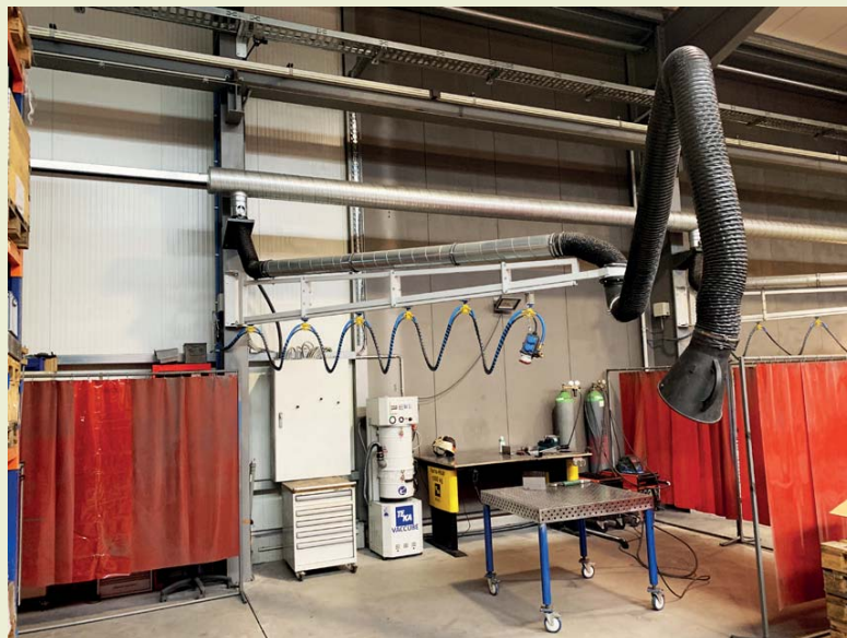
Absaugarm mit Wandausleger und Führungsschiene
