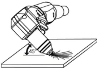
Den Brenner in einem Winkel von 35° - 45° zum Werkstück halten.
