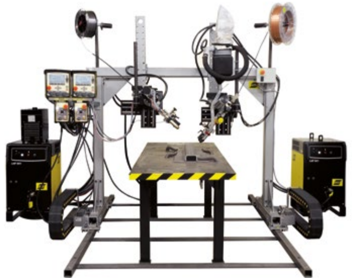
Der Mechtrac ausgerüstet mit A2-Schweißköpfen, Prozesssteuerung PEK und den Stromquellen LAF 631.
