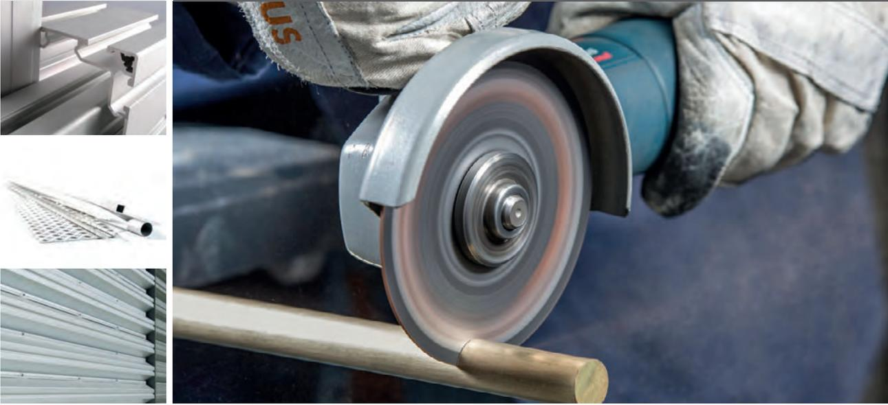
Spezielle Füllstoffe verhindern ein Zusetzen der Scheibe
