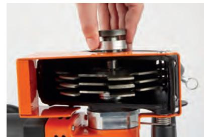
Müheloser Werkzeugwechsel durch geteilte Sicherheits-Spindel und passgenaue Distanzringen
