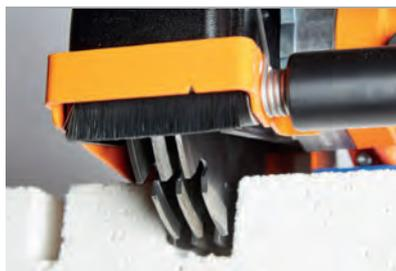
Der geringe Abstand zwischen Schutzhaube und Diamanttrennscheibe ermöglicht ein randnahe Arbeiten bis zu 18 mm.
